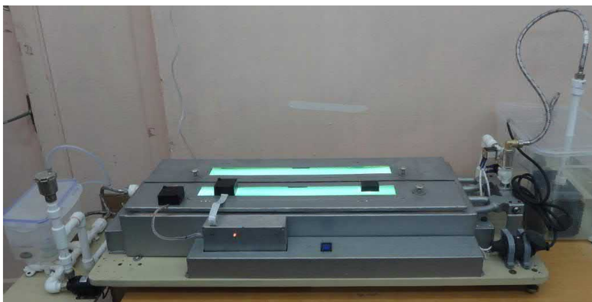
Рисунок 2.3.2. - Общий вид автоматизированной установки фиксации ускоренного старения материалов INSOLATION TOOL
