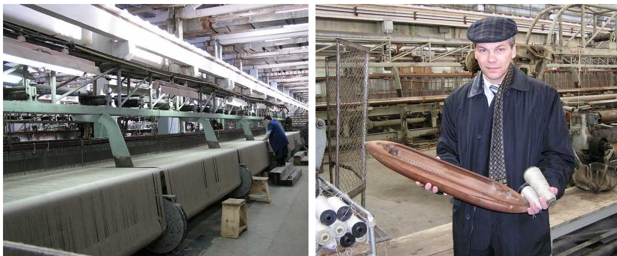
Рисунок 4.2.3. – Ткацкий станок: 1 – станок с заправленными нитями, 2 – челнок использующийся в станке
